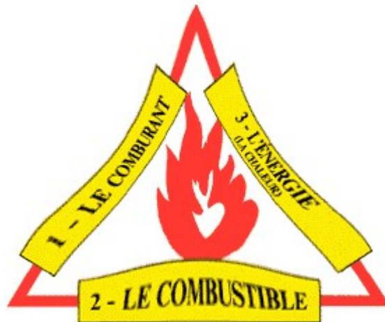
Figure 20 : Eléments nécessaires pour le déclenchement d'un incendie
